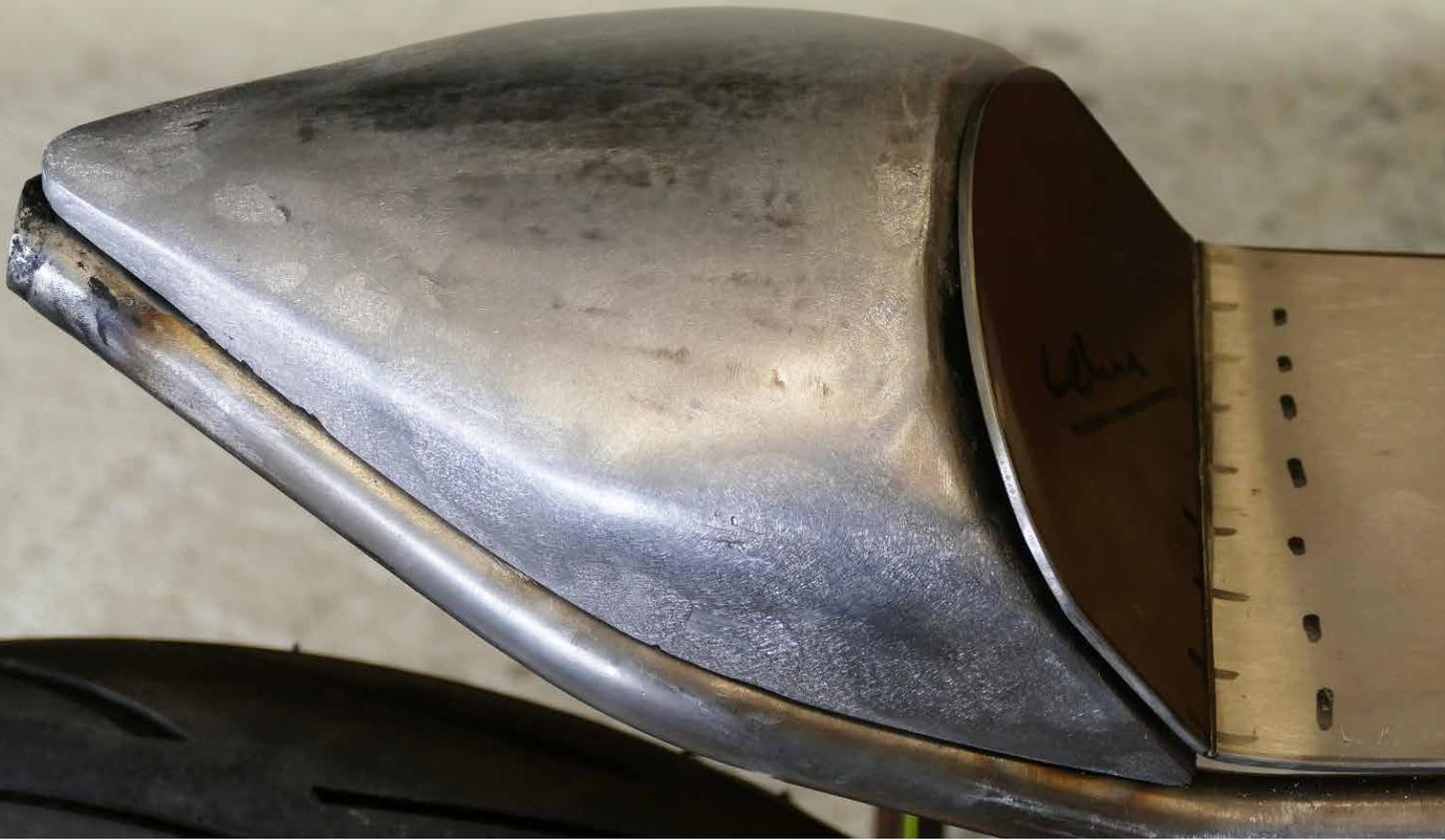
In dieser Folge über die Blechbearbeitung zeigen wir das Formen eines Motorrad Höckers. Um die Form festzulegen, wurde aus einem festen Schaumstoff die Grundform herausgeschliffen. Diese Form dient dazu, die einzelnen Blechteile für die Umformarbeiten detailgetreu anzufertigen. Papierschablonen machen den Anfang und werden anschließend aus dem Blech ausgeschnitten.
